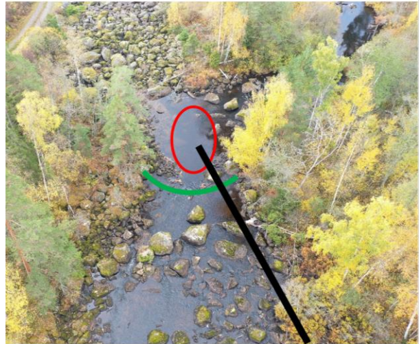
Figur 20. Ungefärlig placering av ny intagspunkt (röd linje) samt tätande vall för utjämningsmagasin (grön linje) och nytt intagsrör (svart linje) enligt utredningsalternativ B.
